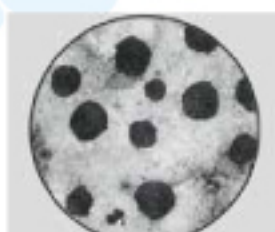
延性鑄鐵的顯微鏡照片
