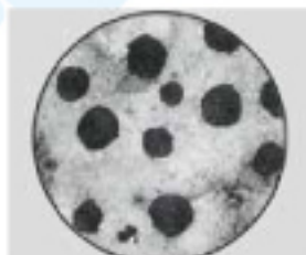
延性鑄鐵的顯微鏡照片
